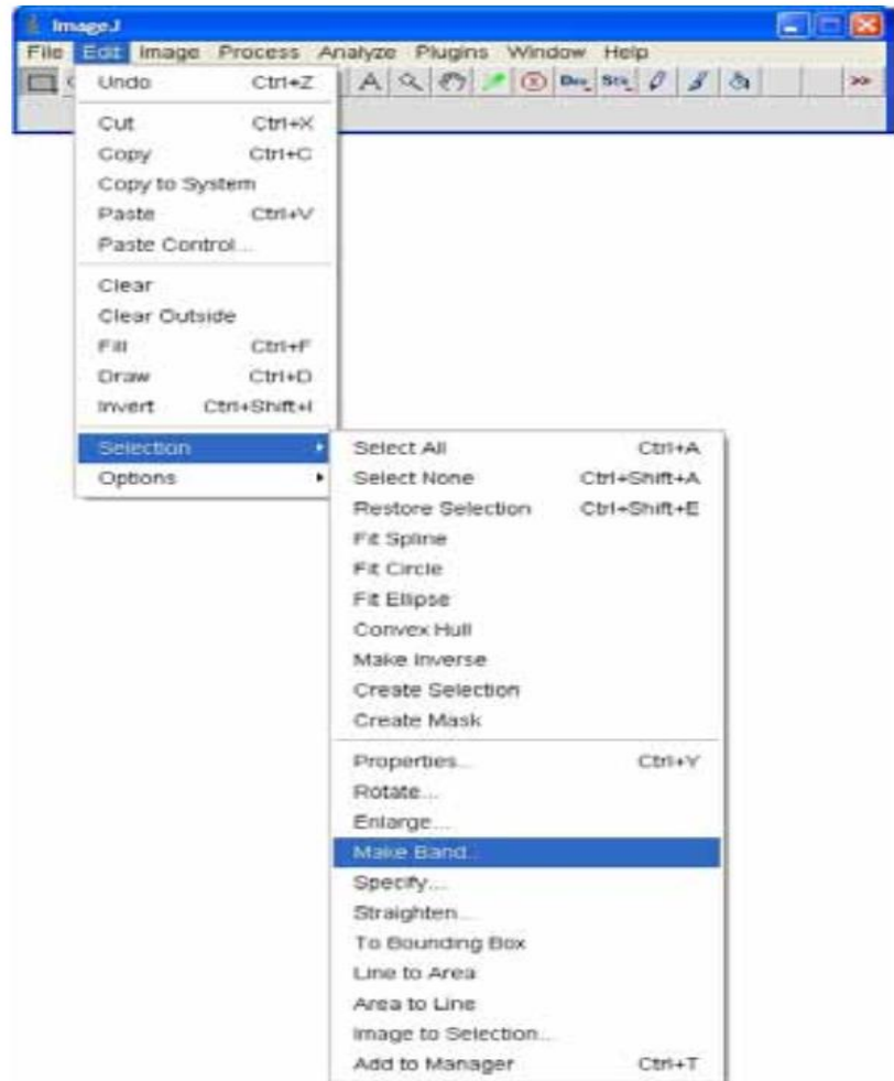
Εικόνα 5 Με τη χρήση του λογισμικού image J είναι δυνατόν να σχεδιαστεί ζώνη (make a band) η οποία περικλείει το αλουμίνιο και μετρά μόνο τα εικονοστοιχεία του ομοιώματος που βρίσκονται γύρω από αυτό
